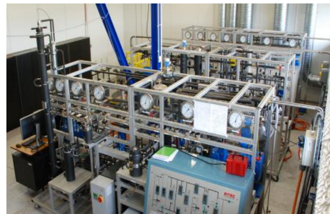
Instalacja do badań ekstrakcji, 1 l/1000 bar
