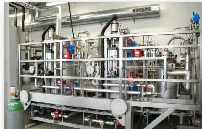
Instalacja do badań ekstrakcji, 2x40 l/1000 bar
