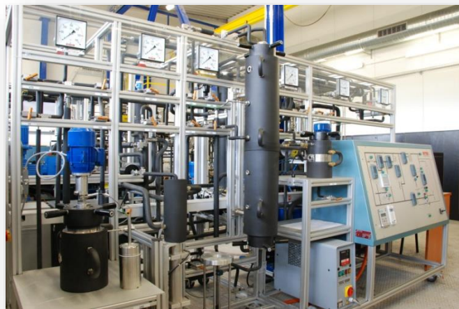
Instalacja do badań micronizacji/impregnacji
